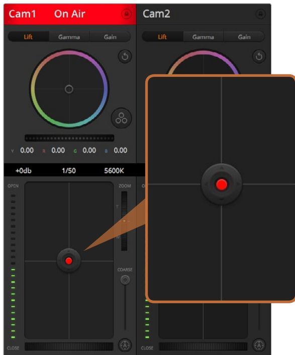
Eine rot leuchtende Blenden-/Schwarzwert-Steuerung zeigt an, dass die jeweilige Kamera auf Sendung ist
