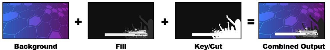
リニアキーを使用したバックグラウンドとフィル/キーの結合
