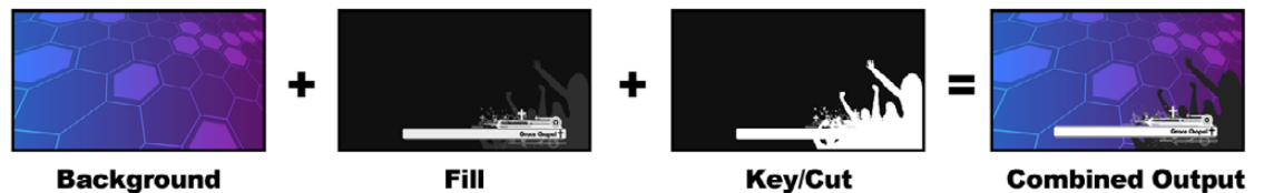
Combiner un arrière-plan ainsi que des signaux fill et key dans une incrustation linéaire
